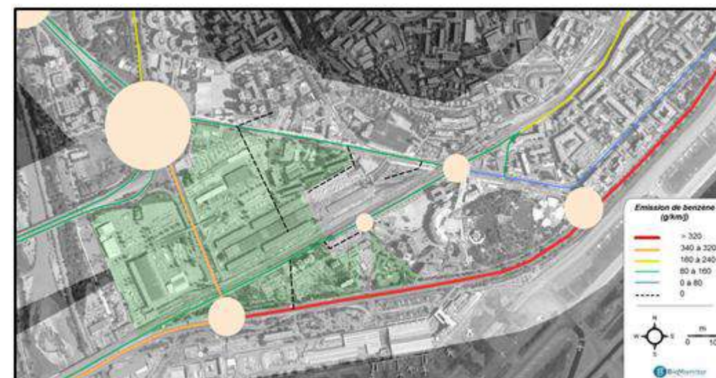
Figure 147 : Répartition géographique des émissions linéiques de benzène pour la situation actuelle (SA - 2010) relatives aux trafics des tronçons étudiés (bioMonitor)
