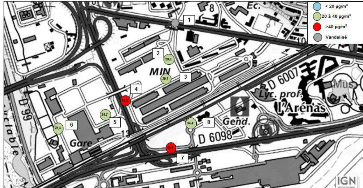
Figure 110 : Concentrations en dioxyde d'azote mesurées sur le domaine d'étude lors de la campagne de mesure en \mu\text{g}/\text{m}^3 (BioMonitor)
