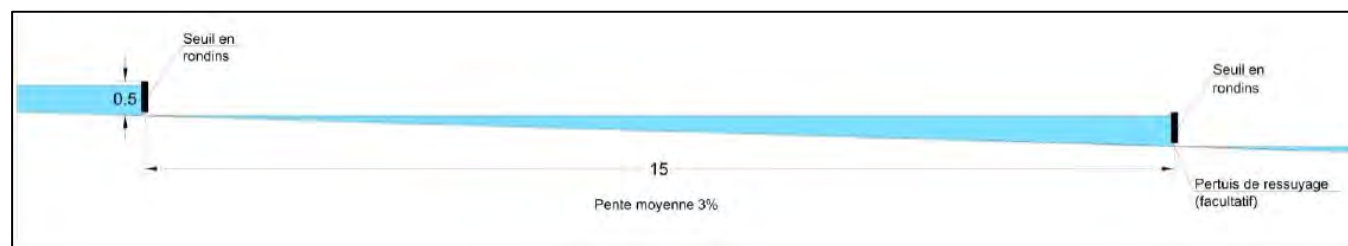
Figure 94 : Profil en long de la noue
