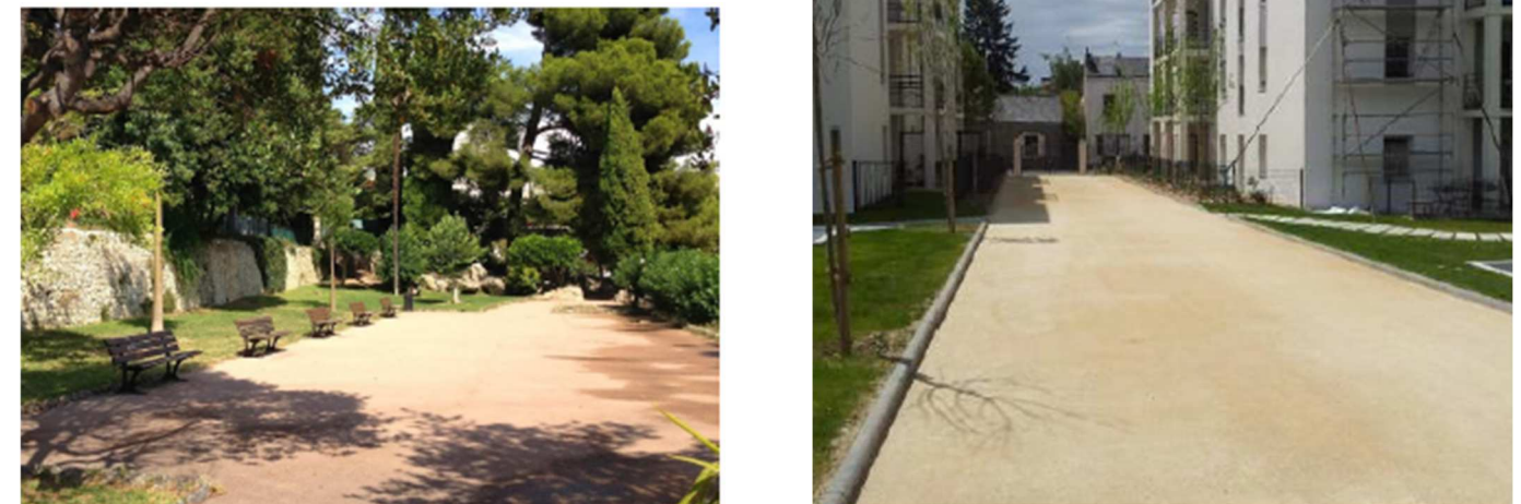
Figure 26 : sable stabilisé mécaniquement (à gauche) et avec un liant (à droite)
