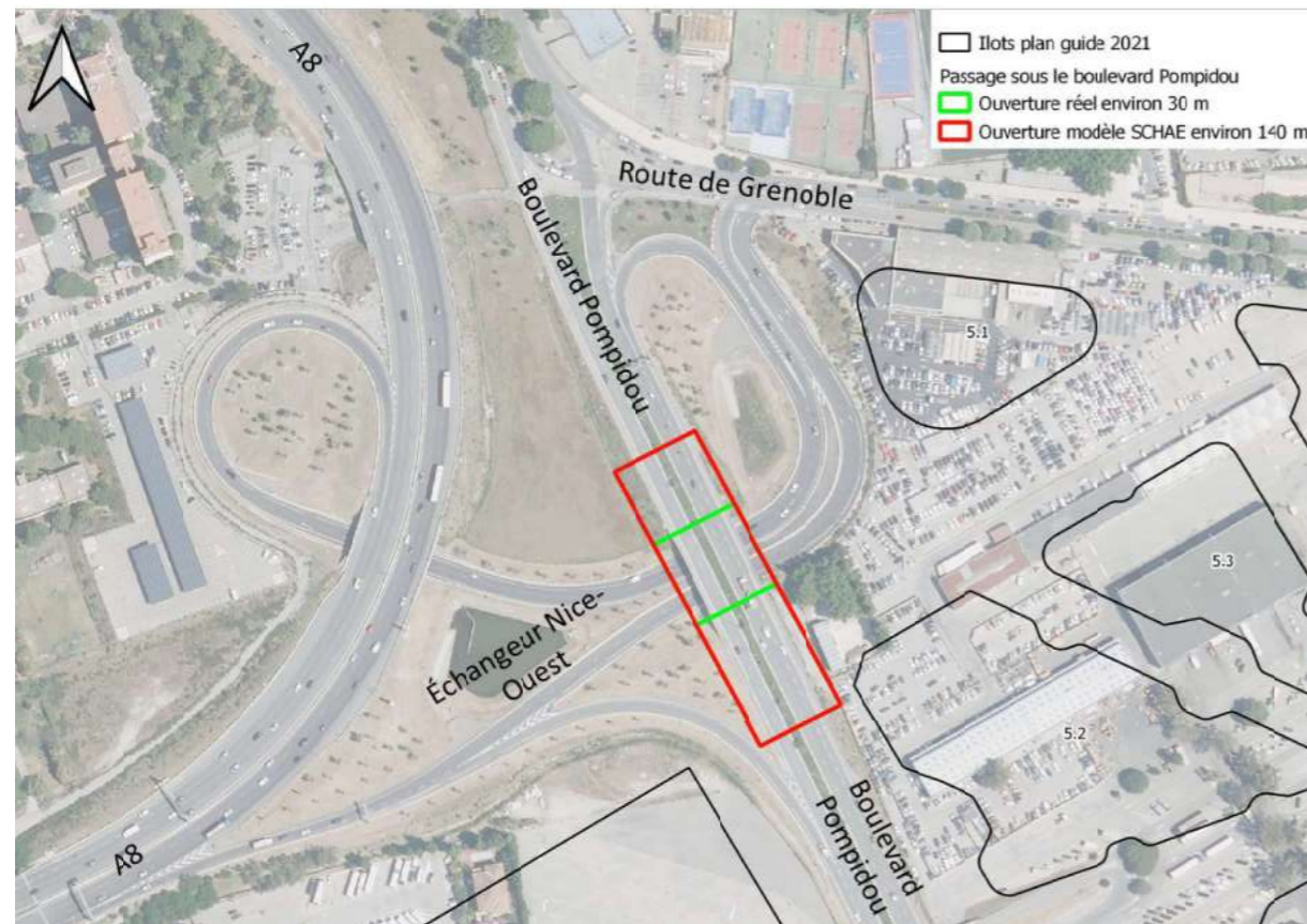
Figure 10 : Passage sous le boulevard Pompidou au droit de l'échangeur Nice-Ouest
