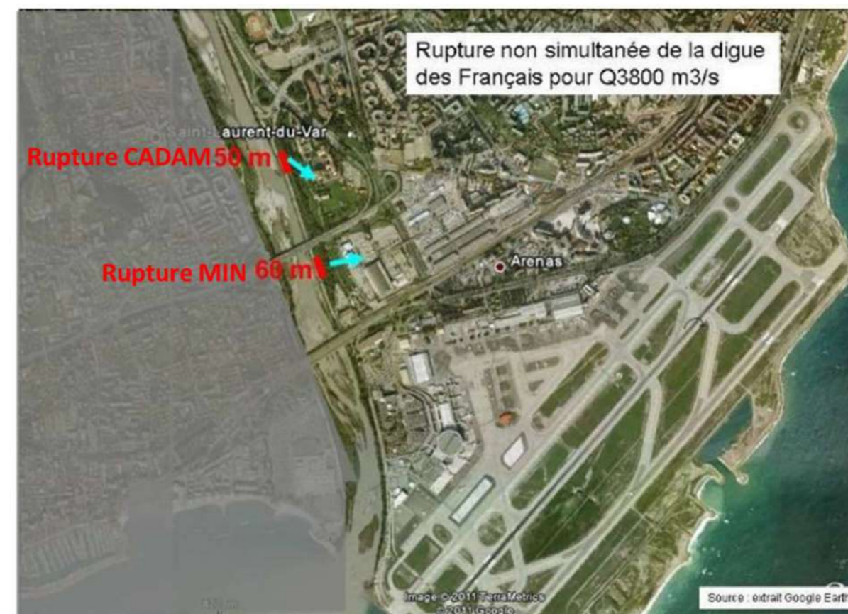
Figure 3 : localisation des ruptures de digue des Français
