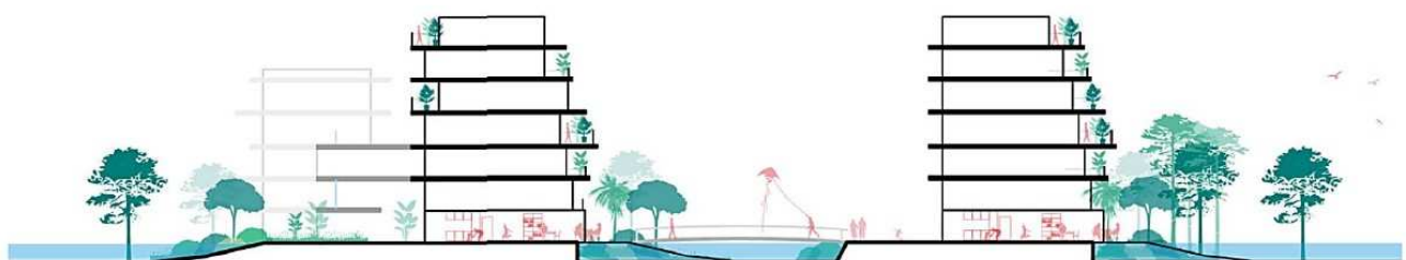
Figure 12 : Principe de construction des « îlots étanches », les parkings souterrains ne sont pas représentés (Source : dossier)
