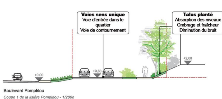
Figure 1 : Coupe de principe de talus planté (source : AVP)
