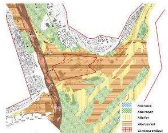
Carte de l'aire de crue exceptionnel avec effacement de digue du PPRI
